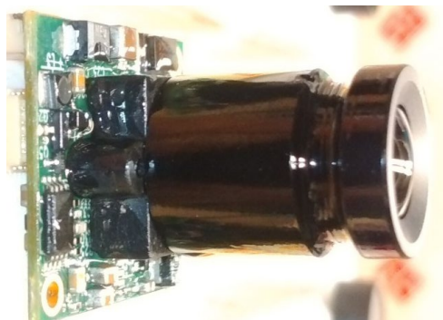
図 3 Jellafin シーリングを施した小型カメラ
