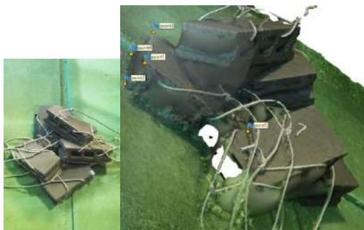
図 1. 水槽実験で使用した構造物の 3D 画像 (左図)、及び精度検証に用いた計測点 (右図内の黄色点)
